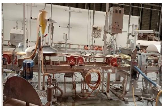
Figure 8 - Zone d'application d'engobe et l'émail.
