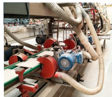
(b) Passage dans la meuleuse d'angle.
